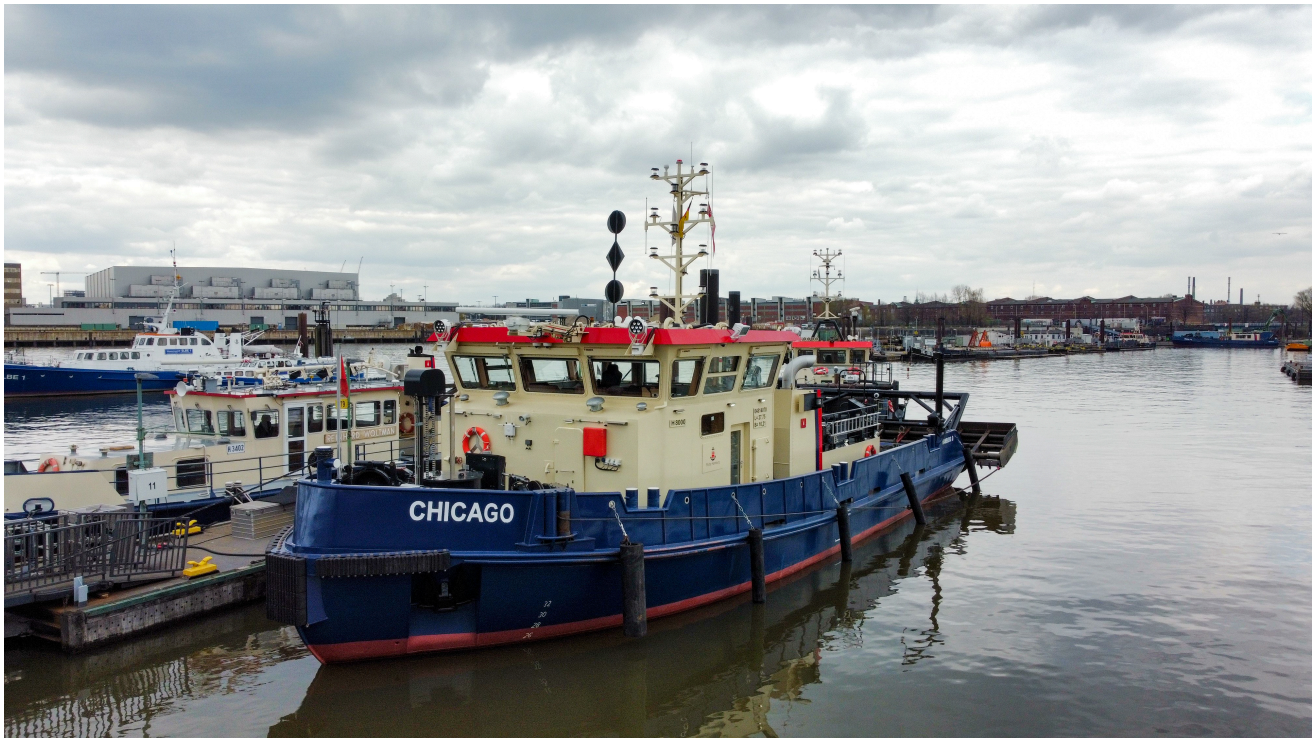
Bild 1) Das Planierschiff Chicago verfügt über einen modernen Hybridantrieb, der aus zwei Dieselmotoren sowie zwei Elektromotoren von BEN Buchele besteht. Letztere unterstützen die emissionsarmen Fahrten innerhalb des Hafengebiets. Bild: ©Reintjes GmbH
